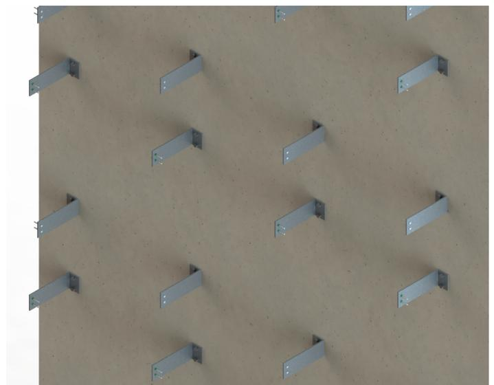
Le dernier point est le plus critique; l'utilisation de l'aluminium, de façon générale, comme matériau de fixation pour des façades est totalement en contradiction avec le traitement des ponts thermiques.
